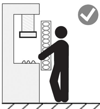
图 3.1.1.2 操作者只有通过 CT6 型安全光栅检测区域才能进入危险区域
