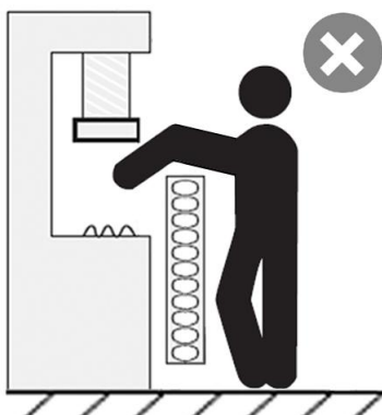
图 3.1.1.4 操作者可以经过 CT6 型安全光栅检测区域的上方进入危险区域（ESPE 偏低）
