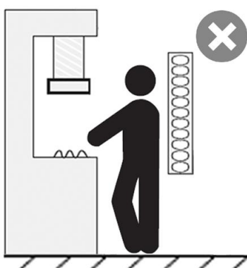
图 3.1.1.3 操作者可以处于 CT6 型安全光栅检测区域和设备危险区域之间
