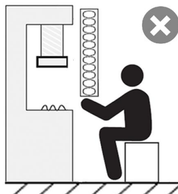
图 3.1.1.5 操作者可以经过 CT6 型安全光栅检测区域的下方进入危险区域（ESPE 偏高）
