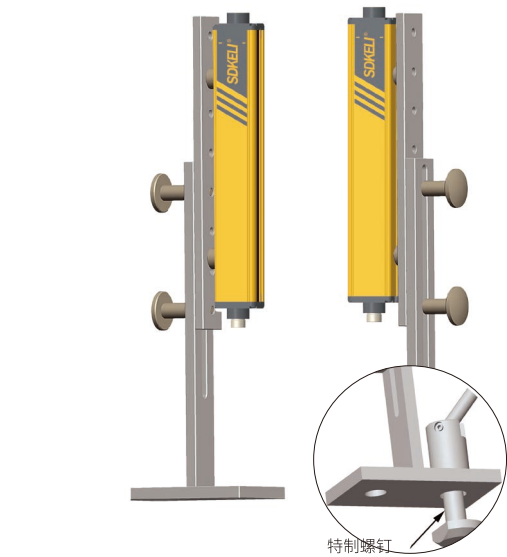
板状支架螺钉安装方式 (BL) 发射器、接收器选用磁吸安装方式安装于板状支架上, 板状支架选用螺钉安装方式装于机床作业台面上。采用该安装方式, 必须有专门的安全管理人员负责管理。
