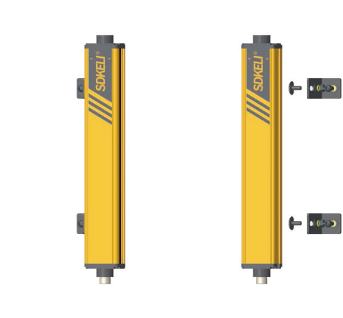
T 型槽侧装方式 (TC) 发射器、接收器通过 T 型螺栓和 L 型弯板支架固定到机床床壁上。
