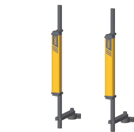
管装支架侧装方式 (GC) 发射器、接收器通过 KS 型管装固定夹固定于钢管支架上, 旋臂座固定在机床底座或立柱上。
