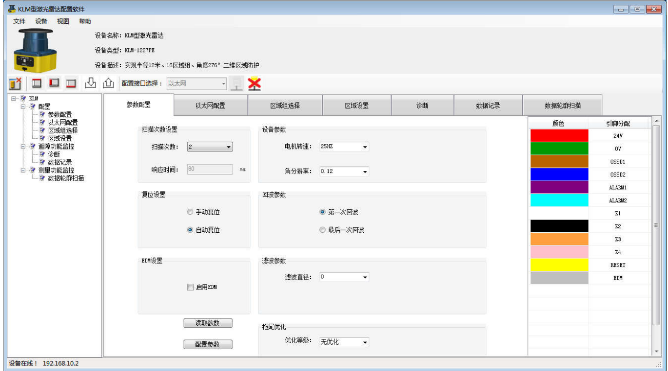
图 2.5 设定区域（双输出型雷达）
